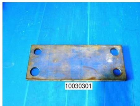
ภาพที่ 2.2-10 แผ่นยืดหยุ่น (Elastomer Pad) เพื่อช่วยลดแรงสั่นสะเทือน
